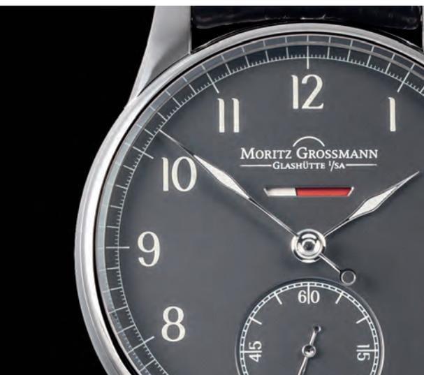
Die Gangreserve-Anzeige zeugt von absoluter technischer Perfektion: Sie ist als zweifarbige Anzeigeelement in Balkenform konzipiert und wird durch ein Differenzialgetriebe gesteuert. Die Balkenanzeige informiert symbolisch über die noch zur Verfügung stehende Laufzeit der Uhr. Bei voll aufgezogener Uhr wird ein komplett weißer Balken gezeigt, bei abnehmender Gangreserve ein zunehmend farbiger Balken gezeigt.
