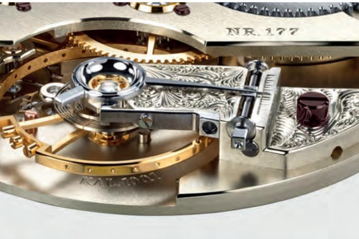
Der gestufte Unruhklöben ist eine Hommage an die Taschenuhren des Uhrmachers Moritz Grossmann und wird mit einer speziellen Regulierschraube ausgestattet. Mit dem Rückzeiger lässt sich die wirksame Länge der Spirale einstellen und damit die Ganggenauigkeit der Uhr regulieren.
