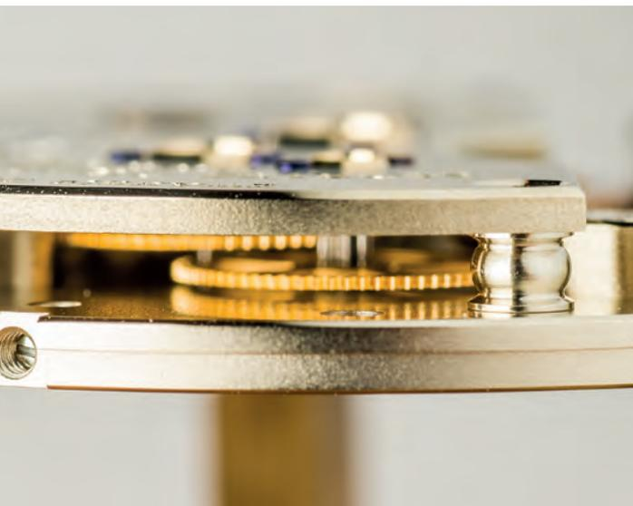
Anstelle von Brücken tritt ein klassisches Pfeilerwerk aus Werkplatte und 2/3-Platine, das für besseren Einblick an den Seiten und leichteren Zugang zu den Werkteilen sorgt. So können die Höhenspiele der Räder genauer eingestellt werden. Die formschön geschwungenen Pfeiler sind eine Reminiszenz an historische Glashütter Taschenuhren.
