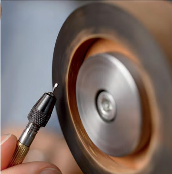
An rotierenden, hölzernen Drehscheiben oder mit Handpolierern werden die Kanten aller Teile - auch derer, die sich für das Auge nicht sichtbar im Inneren des Uhrwerks verbergen - im 45-Grad-Winkel gebrochen und in mehreren Stufen feinpoliert. Die so entstandenen glänzenden Fasen verleihen den einzelnen Komponenten ihre typische Körperlichkeit. Um die Fasen gleichmäßig anzubringen, ist hohes handwerkliches Geschick und ein äußerst gutes Augenmaß erforderlich.
