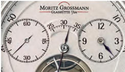
Da der Tourbillon-Käfig im unteren Teil des Zifferblattes den Platz der Minutenanzeige zwischen 25 und 30 verdeckt, hat sich Moritz Grossmann eines kreativen Tricks bedient: Auf einem Sektor in der Mitte des Zifferblattes wird diese Zeitspanne durch die Verlängerung des zentralen Minutenzeigers indiziert.
