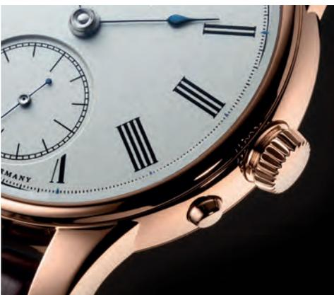
Der Mechanismus schaltet nach einem kurzen Zug an der Aufzugskrone auf Zeigereinstellung um und stoppt gleichzeitig das Uhrwerk. Die Aufzugskrone geht sofort in ihre Ausgangsposition zurück, in der sich die Zeiger nun exakt einstellen lassen. Das Uhrwerk wird über den Drücker unterhalb der Aufzugskrone komfortabel wieder gestartet.
