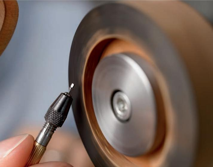
An rotierenden, hölzernen Drehscheiben oder mit Handpolierern werden die Kanten aller Teile - auch derer, die sich für das Auge nicht sichtbar im Inneren des Uhrwerks verbergen - im 45-Grad-Winkel gebrochen und in mehreren Stufen feinpoliert. Die so entstandenen glänzenden Fasen verleihen den einzelnen Komponenten ihre typische Körperlichkeit. Um die Fasen gleichmäßig anzubringen, ist hohes handwerkliches Geschick und ein äußerst gutes Augenmaß erforderlich.
