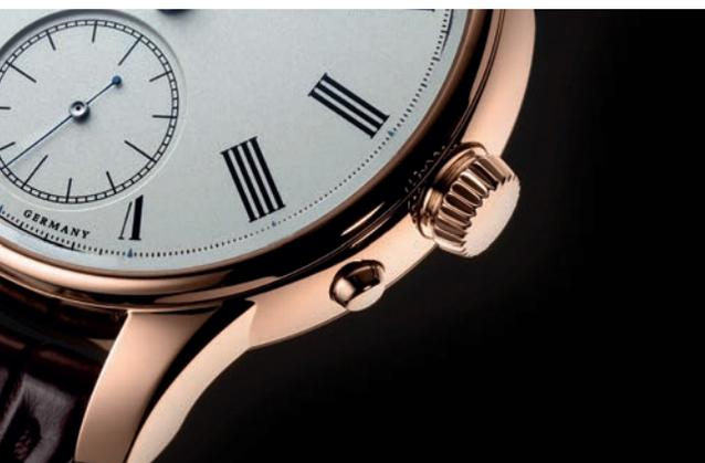
Der Mechanismus schaltet nach einem kurzen Zug an der Aufzugskrone auf Zeigereinstellung um und stoppt gleichzeitig das Uhrwerk. Die Aufzugskrone geht sofort in ihre Ausgangsposition zurück, in der sich die Zeiger nun exakt einstellen lassen. Das Uhrwerk wird über den Drücker unterhalb der Aufzugskrone komfortabel wieder gestartet.
