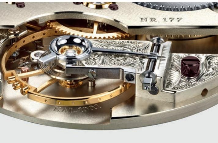
Der gestufte Unruhkloben ist eine Hommage an die Taschenuhren des Uhrmachers Moritz Grossmann und wird mit einer speziellen Regulierschraube ausgestattet. Mit dem Rückzeiger lässt sich die wirksame Länge der Spirale einstellen und damit die Ganggenauigkeit der Uhr regulieren.
