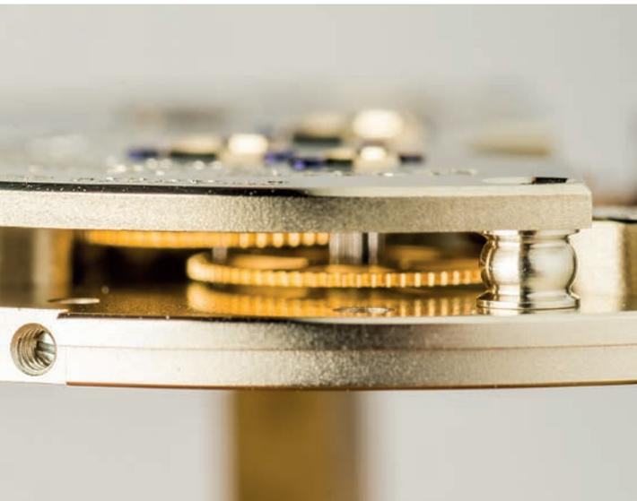
Anstelle von Brücken tritt ein klassisches Pfeilerwerk aus Werkplatte und 2/3-Platine, das für besseren Einblick an den Seiten und leichteren Zugang zu den Werkteilen sorgt. So können die Höhen-spiele der Räder genauer eingestellt werden. Die formschön geschwungenen Pfeiler sind eine Reminiszenz an historische Glashütter Taschenuhren.
