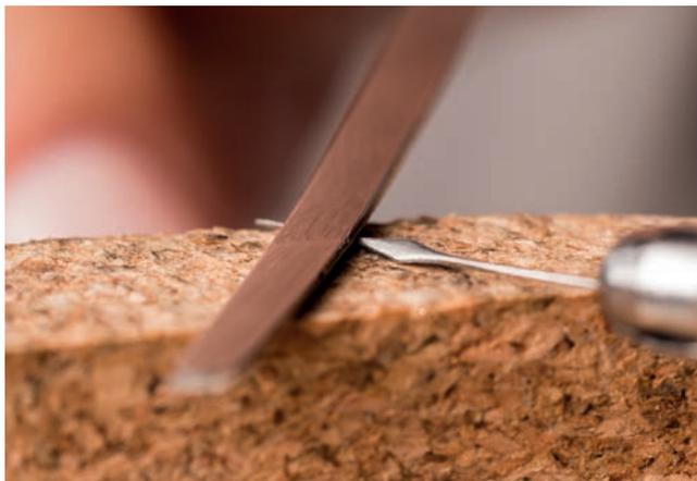
Zunächst wird das Profil des Zeigers aus einem flachen Rohling herausgearbeitet, dann mit Diamantfeilen in die jeweilige Form geschliffen. In diesem aufwändigen Arbeitsschritt erhält jeder einzelne Zeiger seine dreidimensionale Gestalt. Anschließend wird er an einer Holzscheibe aus der freien Hand hochglanzpoliert.
